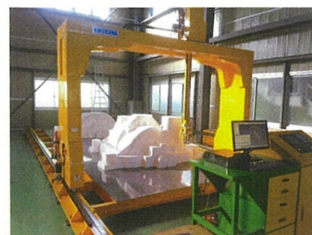
大型NCLレーザ3次元測定機 8,000×3,000×2,000(XYZ)
