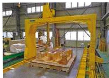
大型NCLレーザ3次元測定機 8,000×3,000×2,000(XYZ)
